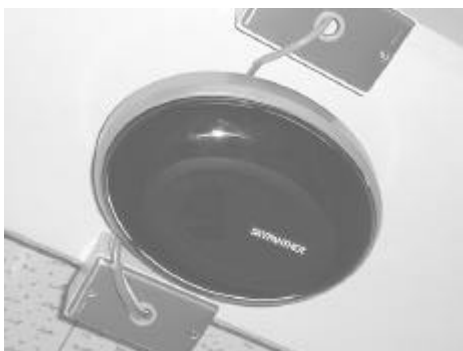
図10 赤外線無線LAN（天井側）
